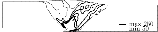
図-4 EPSのみ, 長方形形状, h_{eps}=10\text{ cm} , L_{eps}=90\text{ cm}
