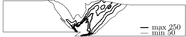
図-6 EPSのみ, 逆台形形状, h_{eps}=10\text{ cm} , L_{eps}=90\text{ cm}
